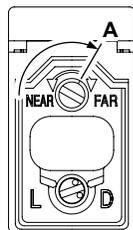
3. 移去检测物体，继续顺时针旋转距离设定调节器直至传感器进入检测状态，然后逆时针方向旋转，找到传感器改变为非检测状态的B点。即使调节器完全顺时针方向旋转，但传感器未进入检测状态，调节器完全旋转到的位置也被视为B点。(此调节器为多旋转式，因此A点至B点可能多旋转一圈以上。)
